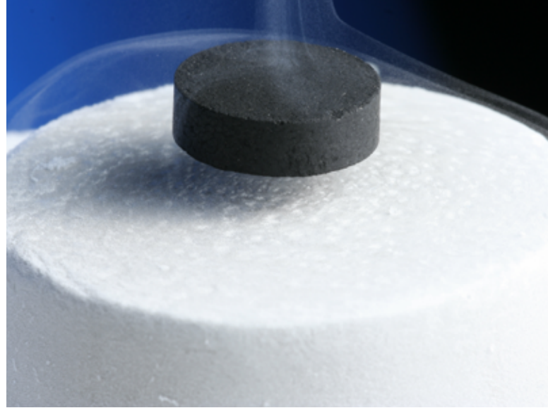
Schwebende Tablette eines Hochtemperatursupraleiters
