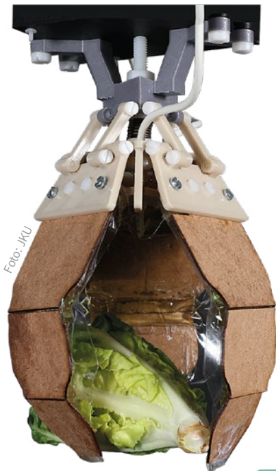
gripper lettuce - kompostierbarer Roboter-greifer
